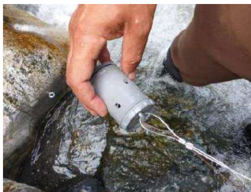
Câble acier et sonde dans une boîte PVC perforée
