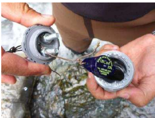
Sonde iBCod dans sa boîte PVC
